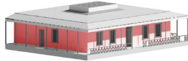
Img. n°74 Esquema (demarcado en rojo) de identificación de tabiques exteriores a intervenir.
