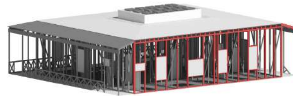
Img. n°72 Esquema (demarcado en rojo) de estructura de muro de tabique eje sur a reparar.
