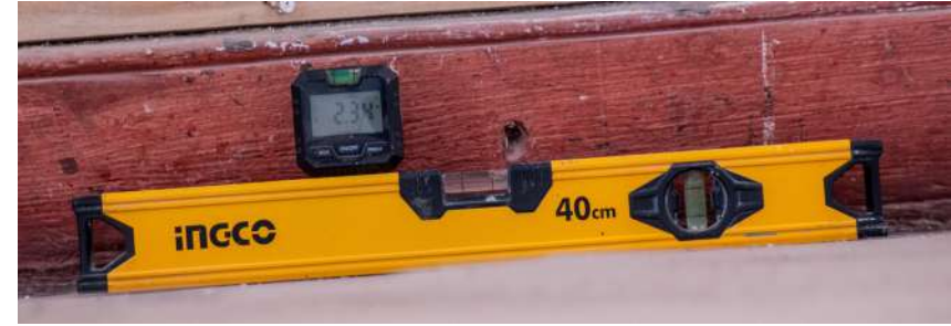
Img. n°64 Registro fotográfico in situ de presencia de desnivel mediante Nivel que determina la horizontalidad, verticalidad e inclinación de superficies. © Corsa Arquitectos ©JP
